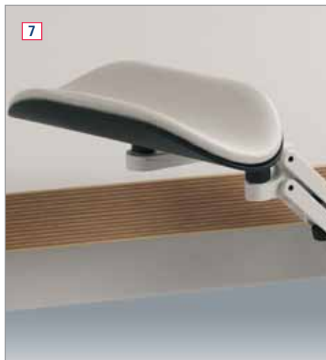
7 Armstützen • Für die ergonomische Stützung der Unterarme. • Stahl-Doppelgelenk-Ausleger lichtgrau. • Auflage Lammnappaleder, hellgrau L x B 200 x 102 mm. Höhe bis 75 mm einstellbar. • Inkl. Schraubklemme, Verstellbereich 15–43 mm.
